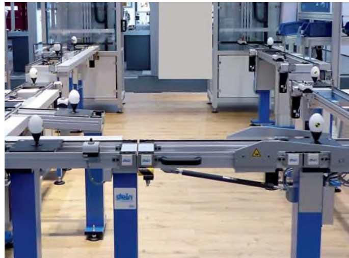
Aus dem modularen Baukastensystem von Stein können Anwender Werkstückträger-Transportsysteme individuell zusammensetzen. Bild: Stein
