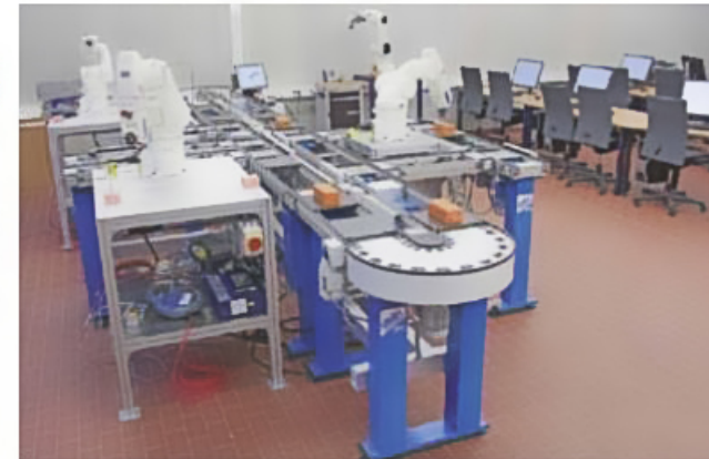
Dank des Rechteck-Layouts kann man jederzeit weitere Prozessstationen einfügen, entnehmen oder außerhalb der Anlage umrüsten
