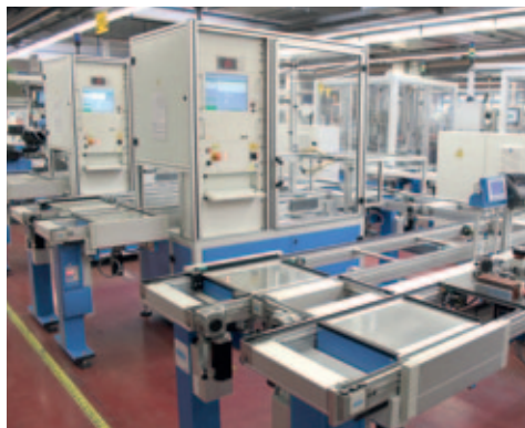
02 Der Produktionsprozess beinhaltet eine Mischung aus Automatik- und Handarbeitsstationen, die vom Werkstückträger-Transportsystem bedient werden
