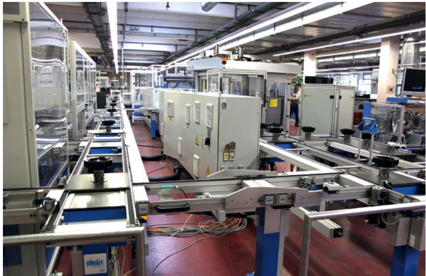
Das hier erkennbare Umlauf-Grundsystem ist Teil einer neuen automatisierten Montageanlage für Ventilatoren, bei dem im Endausbau knapp 100 Werkstückträger umlaufen. Es besteht aus zwei Hauptträngern und den links und rechts angedockten Satelliten, um die einzelnen Stationen zu versorgen. Im Freiraum in der Mitte sind die Versorgungs- und Steuerungs-Einheiten platzsparend angeordnet
