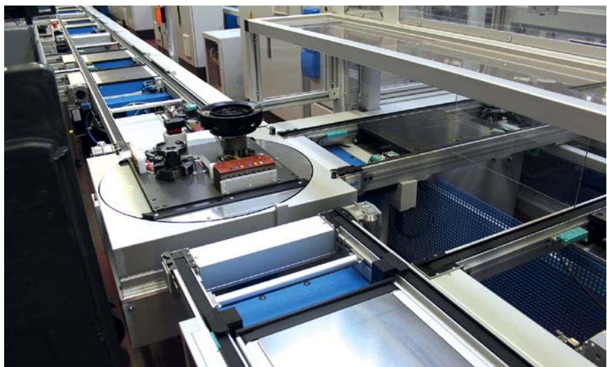
Über die beiden aufeinanderfolgenden Stein-Standardmodule Wendestation und Umlenkstation erfolgen die individuelle, bedarfsgesteuerte Ausschleusung, die Durchfahrt oder die Weiterleitung zur nächsten Arbeits-, Prozess- oder Prüfstation
