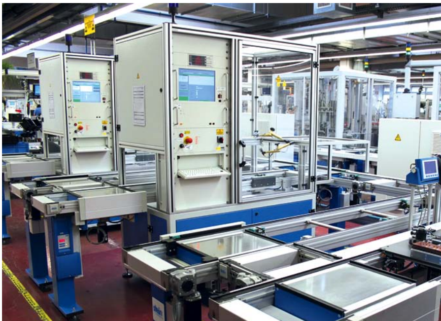
Auch hier wird der produktions- und prozessindividuelle Mix aus Automatik- und Handarbeitsstationen auf Basis von standardisierten Stein-Modulen deutlich, die vom Werkstückträger-Transportsystem ver- und entsorgt werden
