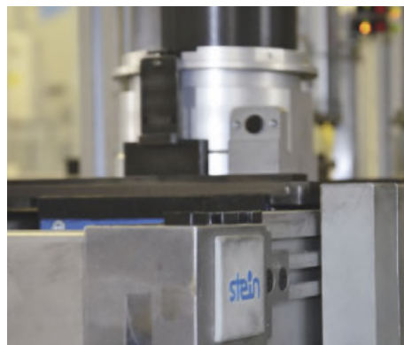
Die Werkstückträger sorgen für einen sicheren und schonenden Transport der Motorenkomponenten
