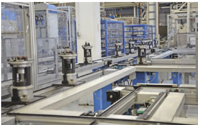
Werkstückträger-Transfersysteme von Stein Automation sorgen bei AMK in Aichwald für einen reibungslosen Materialfluss
