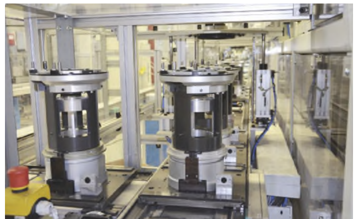
Am laufenden Band werden die Statoren prozesssicher an die Produktions- und Montagestationen gefahren
