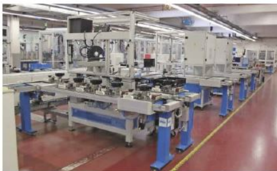
Hochautomatisierte Montageanlage für Ventilatoren: Insgesamt sind im Transportsystem im Endausbau knapp 100 Werkstückträger im Umlauf
