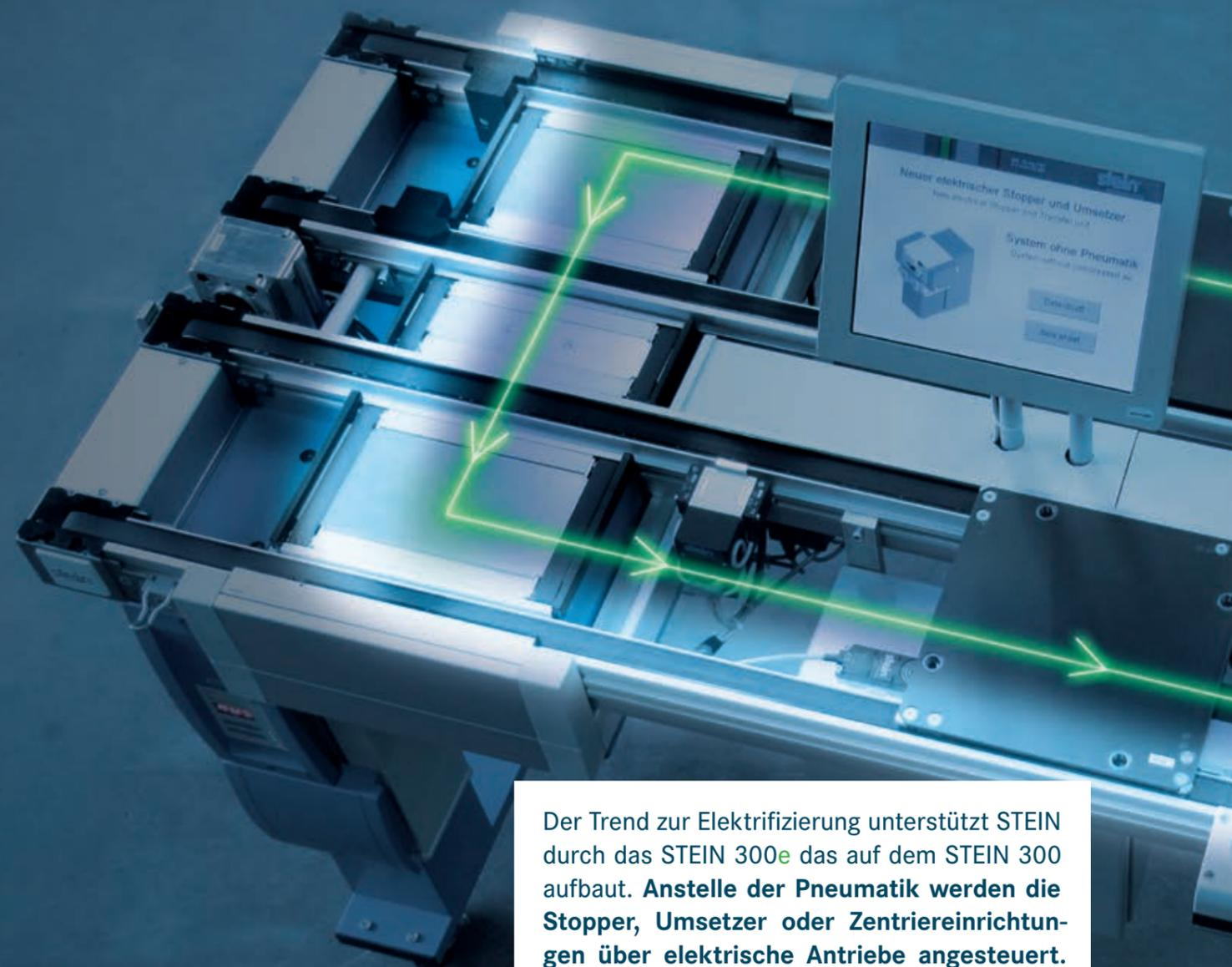
Der Trend zur Elektrifizierung unterstützt STEIN durch das STEIN 300<sup>e</sup> das auf dem STEIN 300 aufbaut. **Anstelle der Pneumatik werden die Stopper, Umsetzer oder Zentriereinrichtungen über elektrische Antriebe angesteuert.** Dies ist gerade für den Reinraum von großem Vorteil. Als Nebeneffekt unterstützen Sie den grünen Daumen für Ihre Produktion.
