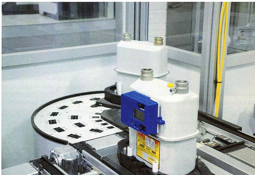
Bild 3. Die Anlagen entstehen größtenteils aus dem modularen Baukasten. Spezielle Anpassungen gab es beispielsweise im Kurvenbereich. Bild (4): Stein/Elster
