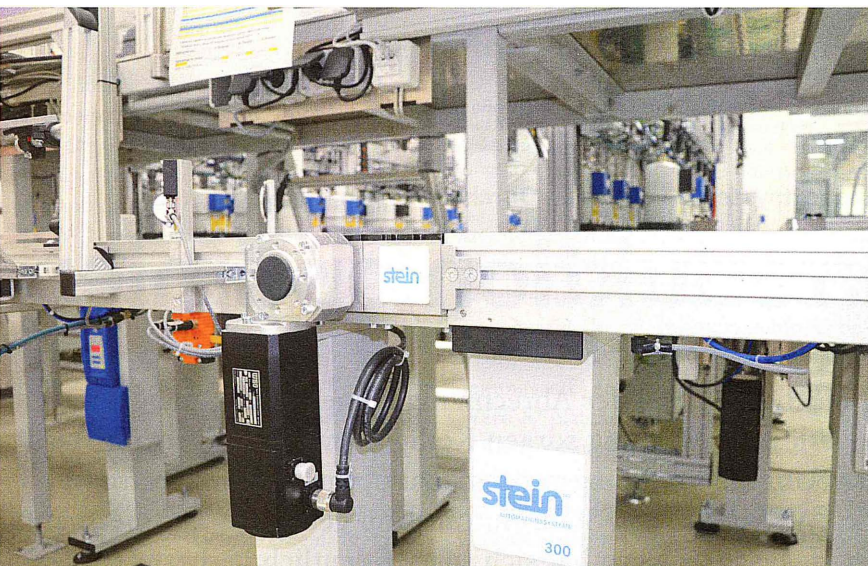
Bild 2. Ein zweites Werkstückträger-Transportsystem ver- und entsorgt eine von Elster entwickelte automatisierte Prüflinie für Gaszähler.
