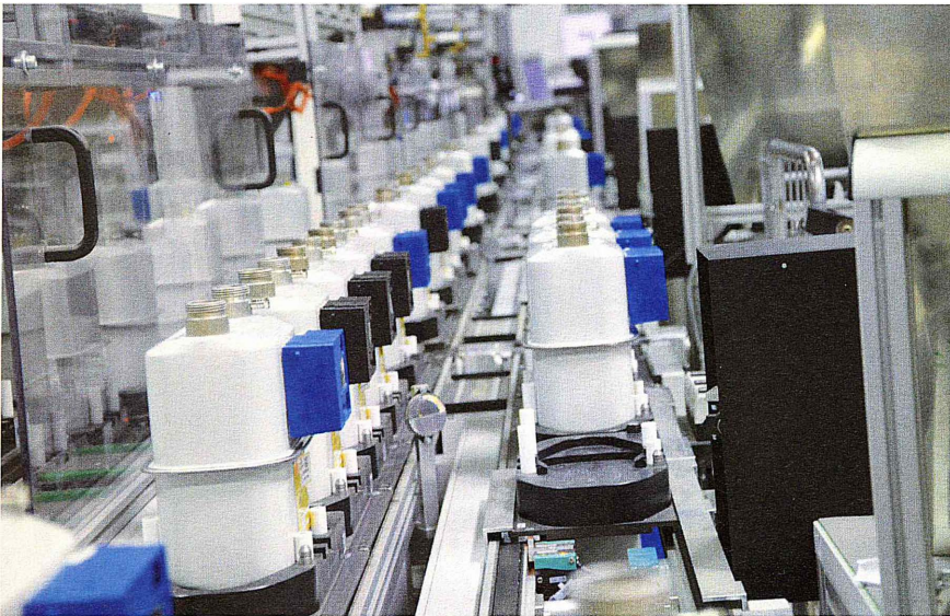
Bild 1. An der Anlage von Stein montieren Mitarbeiter elektronische Zählwerke an die Gaszähler.
