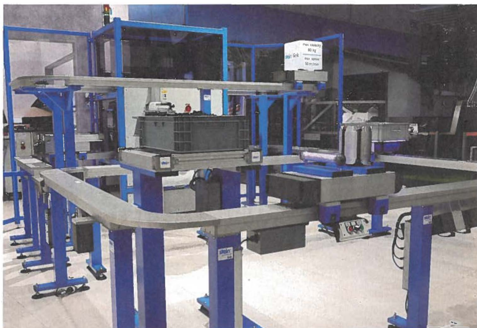
STEIN link® mit Lift und Strecke auf zwei Ebenen – kombinierbar mit Kurve, Weiche, Arretierung sowie Akkuwechselstation.
