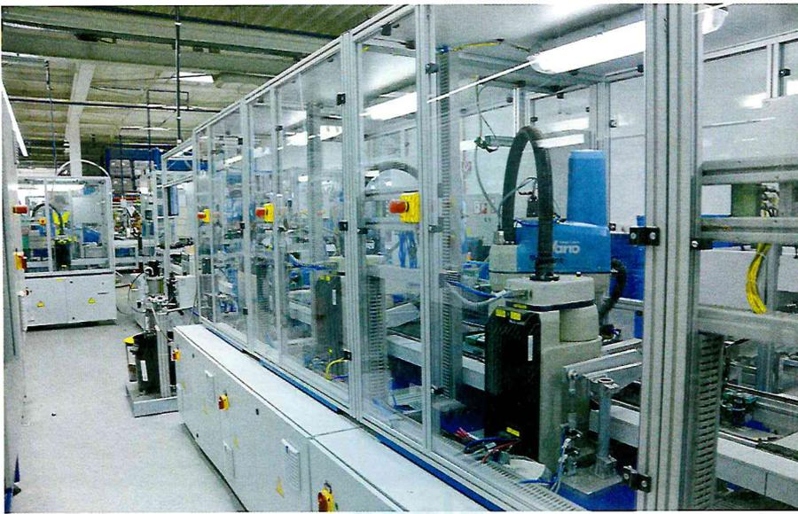
Bild 3. An insgesamt neun Stationen laufen die Montageprozesse automatisiert ab.
