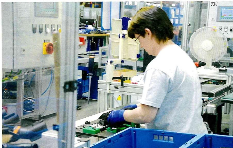
**Bild 2.** Handarbeitsplatz: Im Anschluss an die Automatikstationen findet ein weiterer Montageschritt manuell statt.
