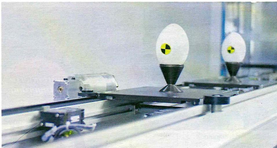
Ein Werkstückträger-Wechsel bei einem Standard-Plattenmaß von 240 x 240 mm dauerte bislang im Durchschnitt 1,5 s. Mit dem Schnelleinzug verkürzt sich diese Zeit auf 0,5 s. Dadurch erzielt der Betreiber einen deutlich höheren Anlagen-Output.
