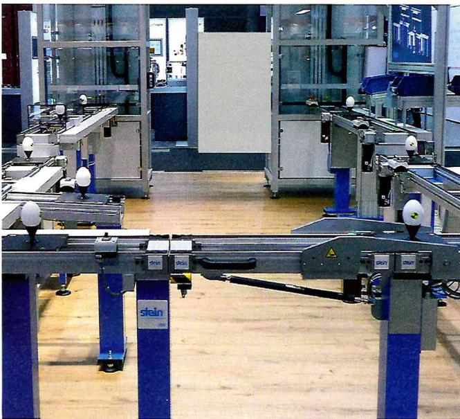
◀ Aus dem modularen Baukastensystem von Stein können Anwender Werkstückträger-Transportsysteme individuell zusammenstellen. (Bilder: Stein Automation GmbH & Co. KG)
