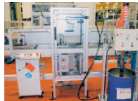
Inline-Automatikstation »Fetten«, die extern erstellt wurde und komplett in den WTS-Materielfluss integriert ist.
