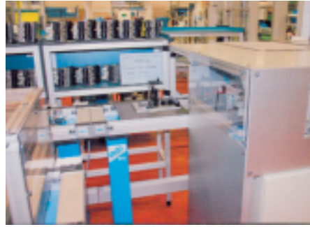
Inline-Automatikstation »Vakuumprüfung« als ebenfalls voll integrierte Einheit, die zunächst extern erstellt und dann in den WTS-Materialfluss eingefügt wurde.
