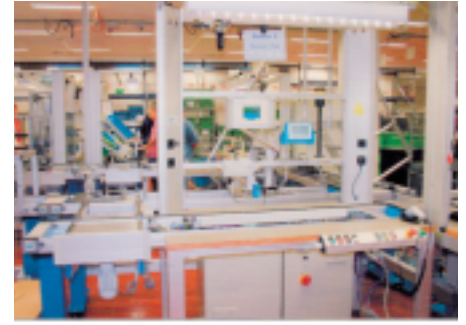
Dieser »Offline-Reparaturplatz wird über einen Materialfluss-Bypass vgr- und entsorgt. Das WTS von STEIN Automation bietet dazu vielfältige Konfigurationsmöglichkeiten.
