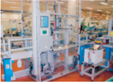
Inline-Automatikstation zum Verschrauben der Elektronik-Baugruppe mit dem Grundgerät, wobei hier der Werkstückträger zur Baugruppen-Bearbeitung ausgehoben und fixiert wird.
