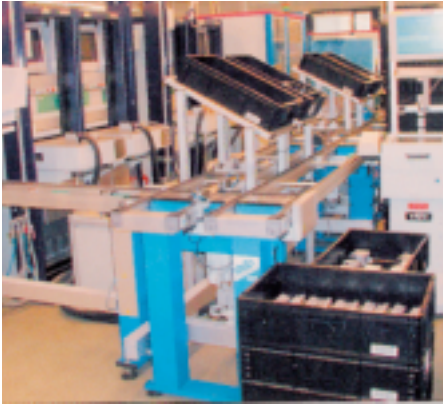
Ausschleusband für die Entnahme und die abschließende Sichtprüfung der fertigen Baugruppen, basierend auf WTS-Transportmodulen von Stein.
