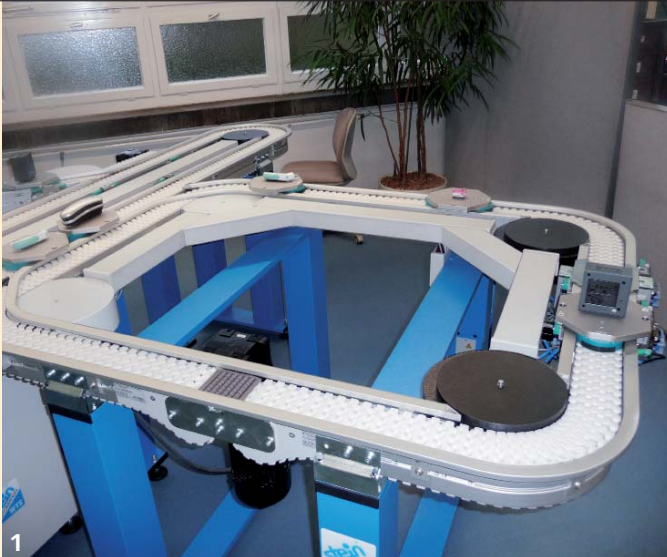
1 Die Ausschleusung von Werkstückträgern zur Beschickung einer Arbeitsstation ist als Satellit an eine WTS-Chain-Anlage angedockt.
